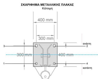
Εικόνα 5: Σκαρίφημα μεταλλικής πλάκας
